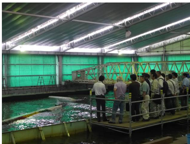
平面水槽での防波堤効果実験
