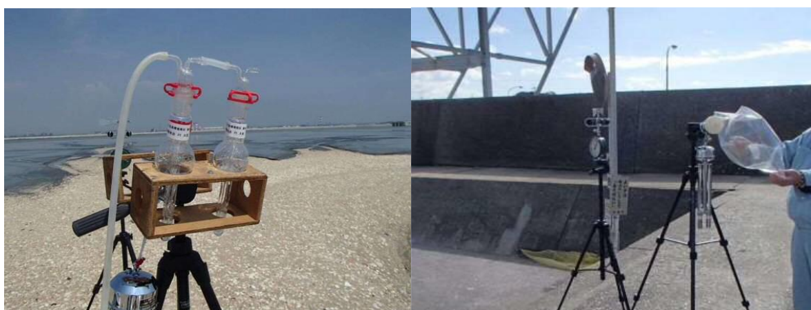
特定悪臭物質の調査状況（試料採取）
