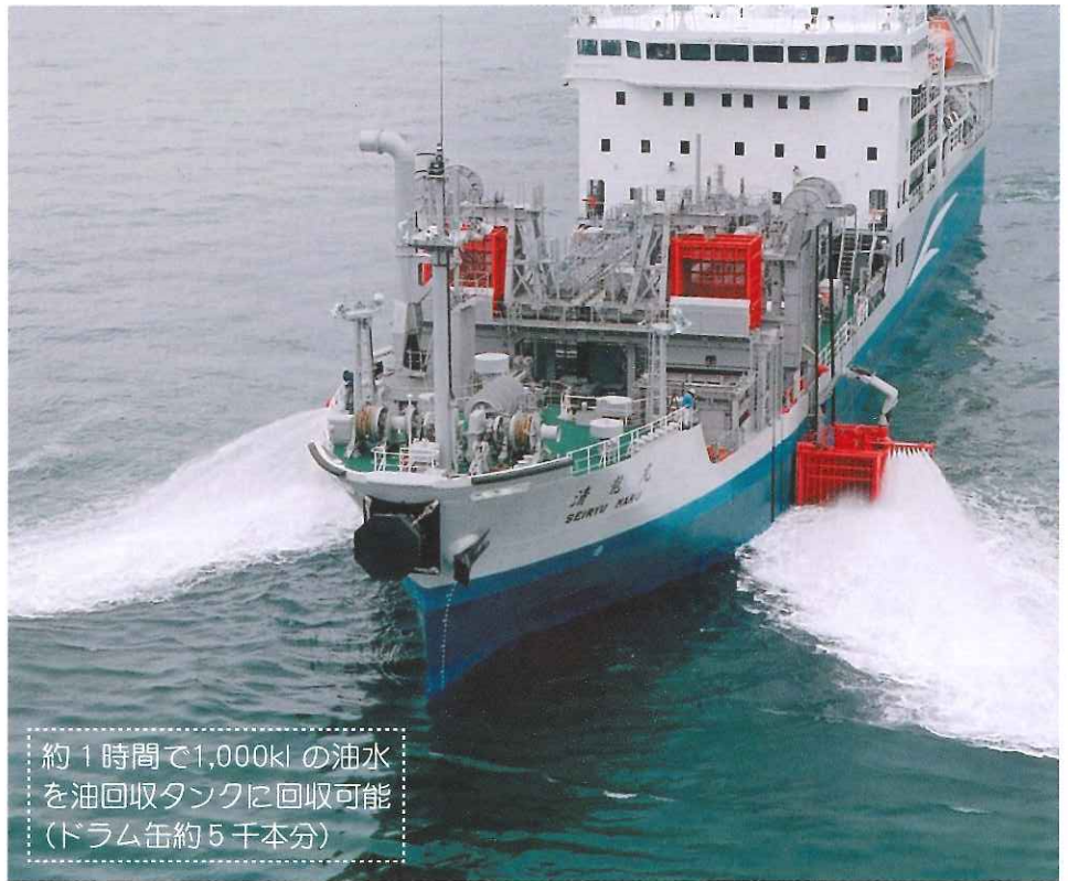
低粘度油回収状況（水ジェット集油装置使用時）
