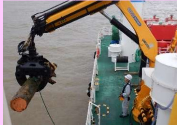
クレーン(0.99t吊)
