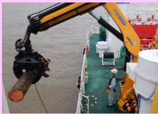
クレーン (0.99t吊)
